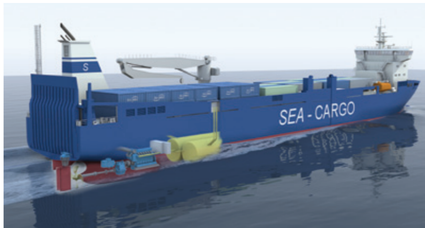
Illustratie nieuwbouw Hull 357 van Sea-Cargo, voortgestuwd met LNG Met vriendelijke toestemming van Sea-Cargo
